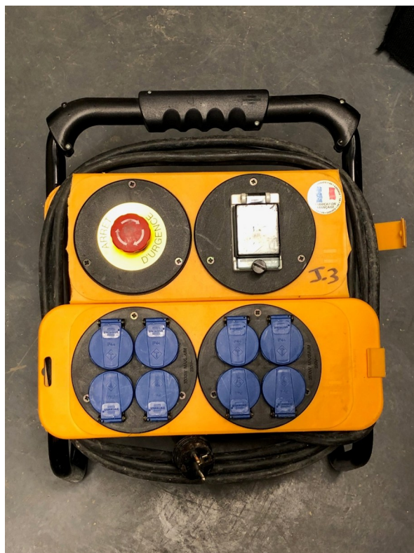
Coffret électrique 220 V, 16 ampères
